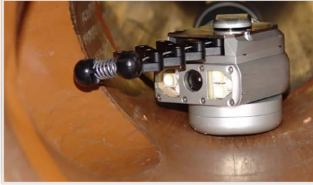
Abbildung 30 | Satellitenkamera im Hauskanal
